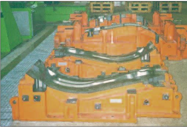
Matrices de fundición a las que se les ha aplicado una capa de dureza uniforme y controlada en las zonas críticas que lo precisan.
